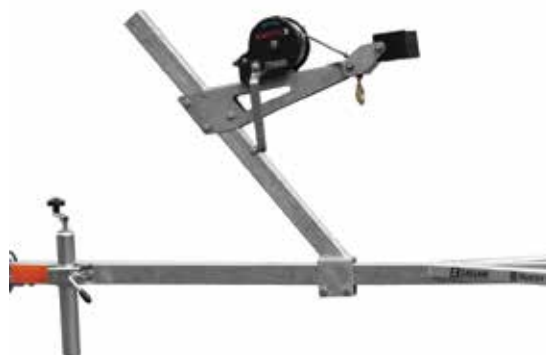
Regulowana dziobnica z wciągarką paskową marki KNOTT
