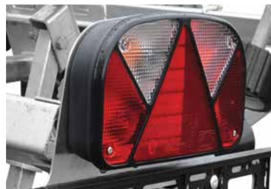
Tyłny panel świetlny w modelach Water Jet Ski+ i R+ odchylane lampy na boki po skosie
