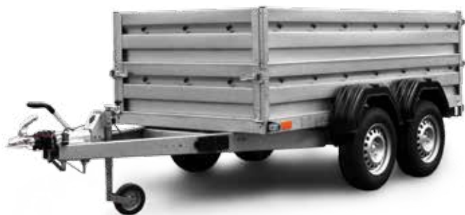
NADSTAWY BURTOWE 350 mm zwiększające objętość przyczepy o 100%
