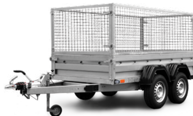
Nadstawa siatkowa do zabezpieczania ładunku o wysokości 800 mm
