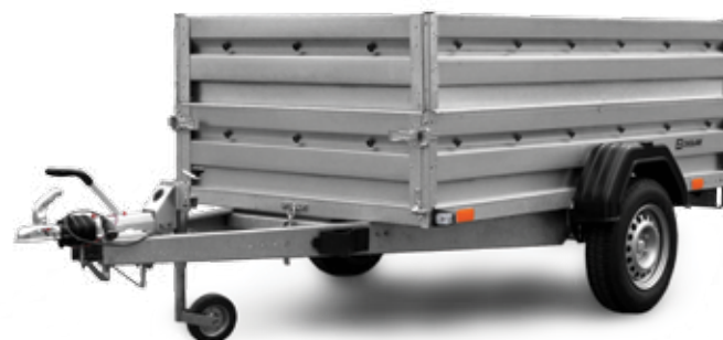
Nadstawy burtowe 350 mm zwiększające objętość przyczepy o 100%
