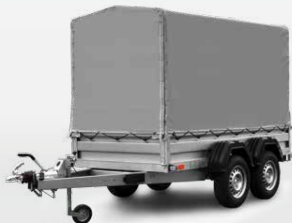
PLANDEKA ZE STELAŻEM do zabezpieczania ładunku o wysokości 1500 mm
