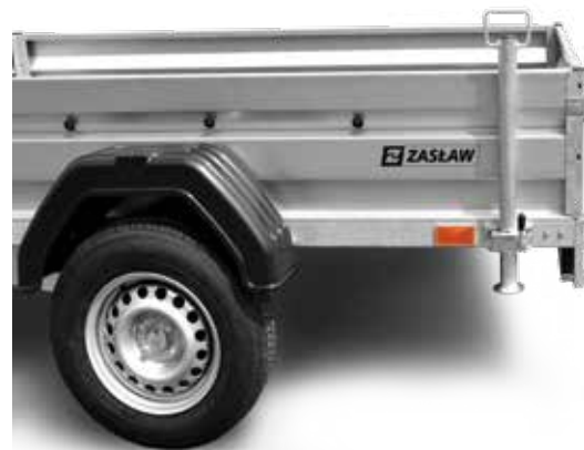
Podpory boczne użyteczne podczas załadunku przyczepy, która nie jest połączona z pojazdem
