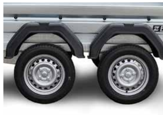
Do produkcji tandemu zastosowano dwie osie po 750 kg
