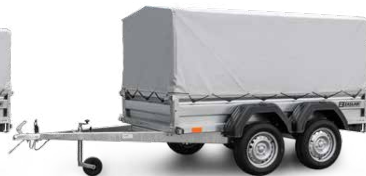
PLANDEKA ZE STELAŻEM do zabezpieczania ładunku o wysokości 1000 mm
