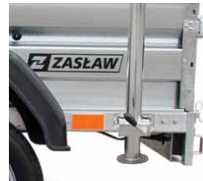
PODPORY BOCZNE użyteczne podczas załadunku przyczepy, która nie jest połączona z pojazdem
