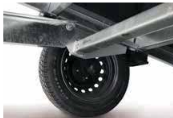
Długie wsporniki mocowania osi - mocowane na trzy punkty montażowe
