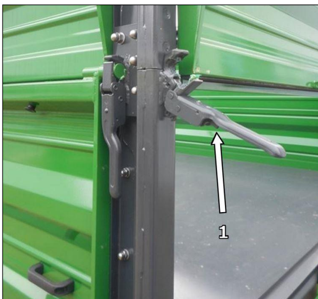
Rys. 24 - Otwieranie dźwigni zamków burt.
