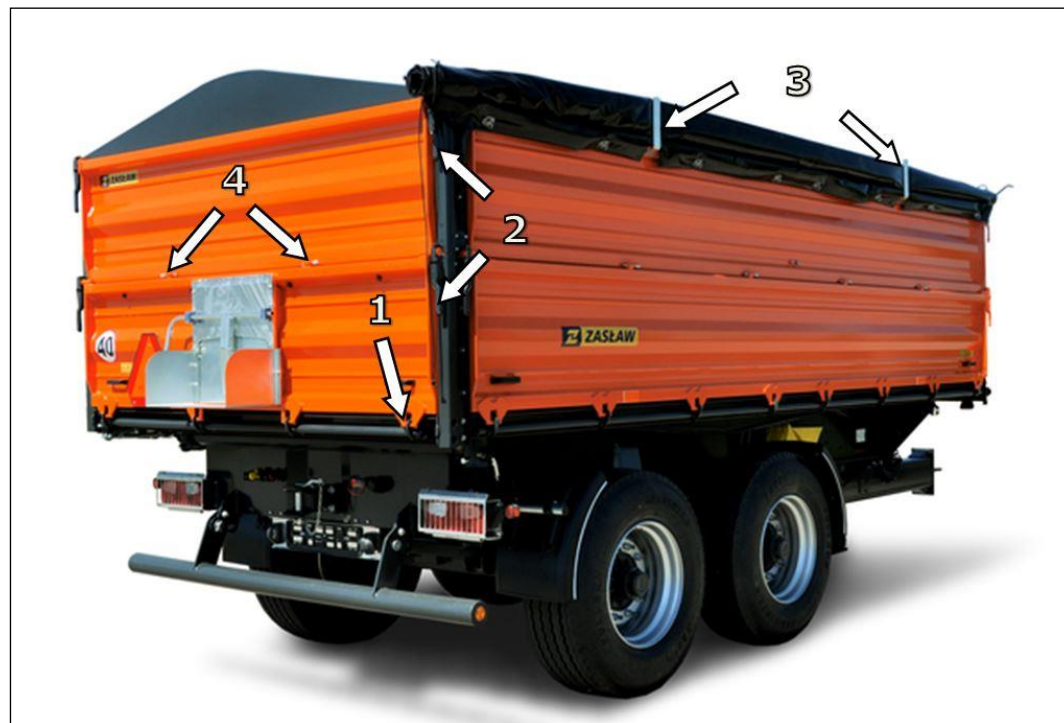
Rys. 17 - Położenie zawiasów i zamków burt w przyczepie
