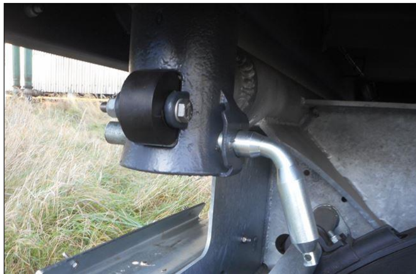
Rys. 18. - Zabezpieczony sworzeń wywrotu.
