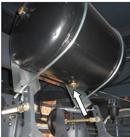
Rys. 37. – Położenie zaworu odwadniającego w zbiorniku.
