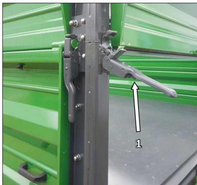
Rys. 23. - Otwieranie dźwigni zamków burt.
