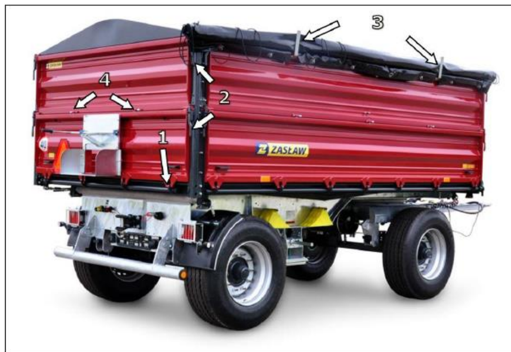
Rys. 16. - Położenie zawiasów i zamków burty w przyczepie.
