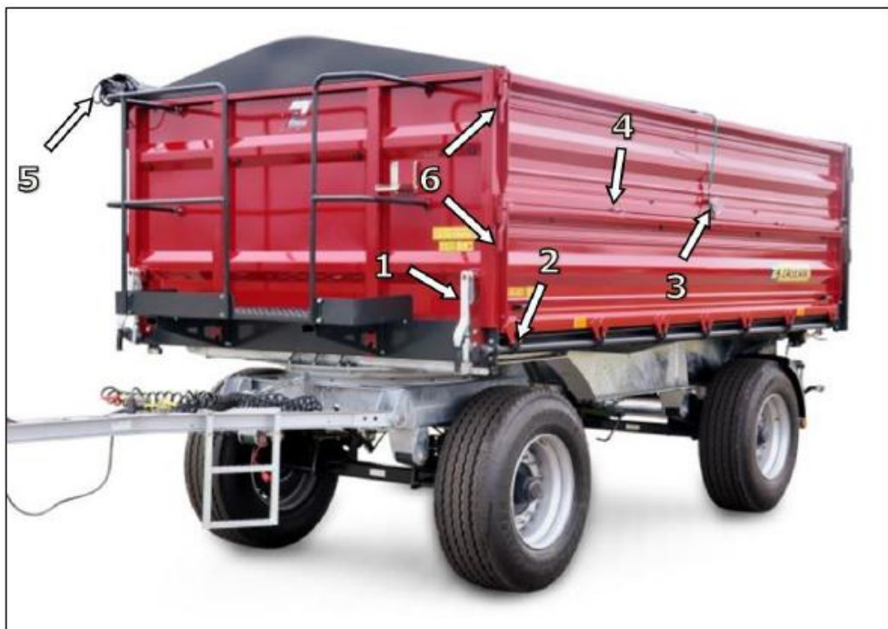
Rys. 17. - Położenie zawiasów i zamków burty w przyczepie.
