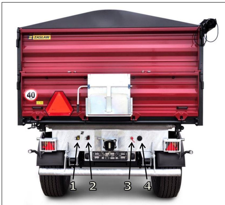
Rys. 15. - Złącza dostępne z tyłu przyczepy.
