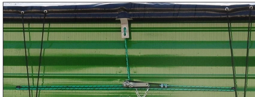
Rys. 21. - Ułożenie linki do rozwijania plandeki.
