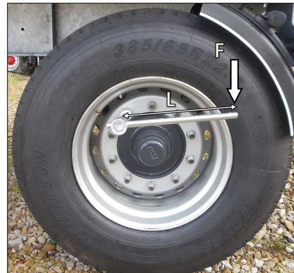
Rys. 38. - Dokręcenie nakrętek koła
