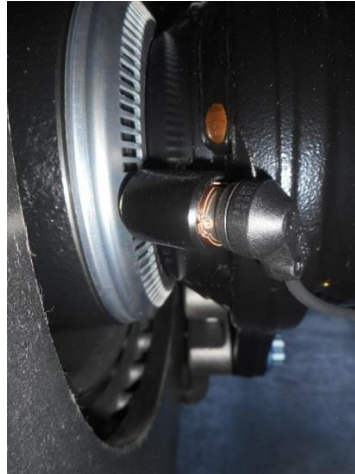
Fot. 9 Czujnik prędkości i pierścień zębaty
