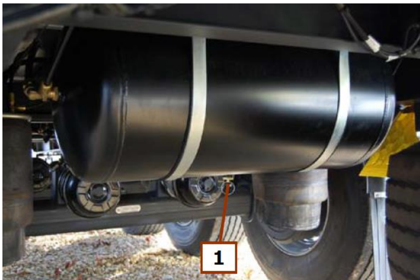
Fot. 3 Zbiornik powietrza
